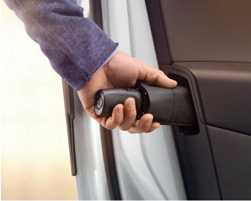
حيز خاص لتخزين المظلة للأيام الماطرة. مع ممرات خاصة لتصريف المياه وإبقاء المقصورة جافة.
